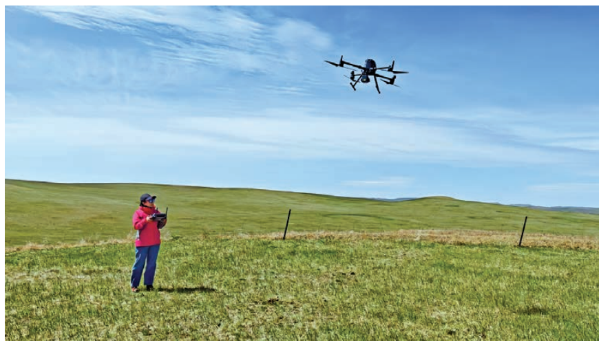
中国黄金集团成功研发“多旋翼无人机多功能超低空空测量—磁法系统”
