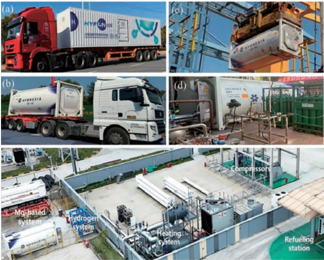
图1 镁基固态储氢吨级储运装备与多场景应用示范：(a) 管束式吨级镁基固态储运氢车；(b) 罐槽式镁基固态储运氢车；(c) 出海运输示范；(d) 氢冶金应用示范；(e) 加氢站应用示范。
