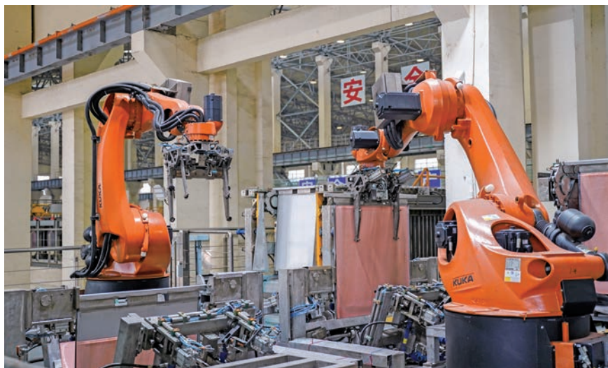
车间里机器人手臂正搬运着铜板
