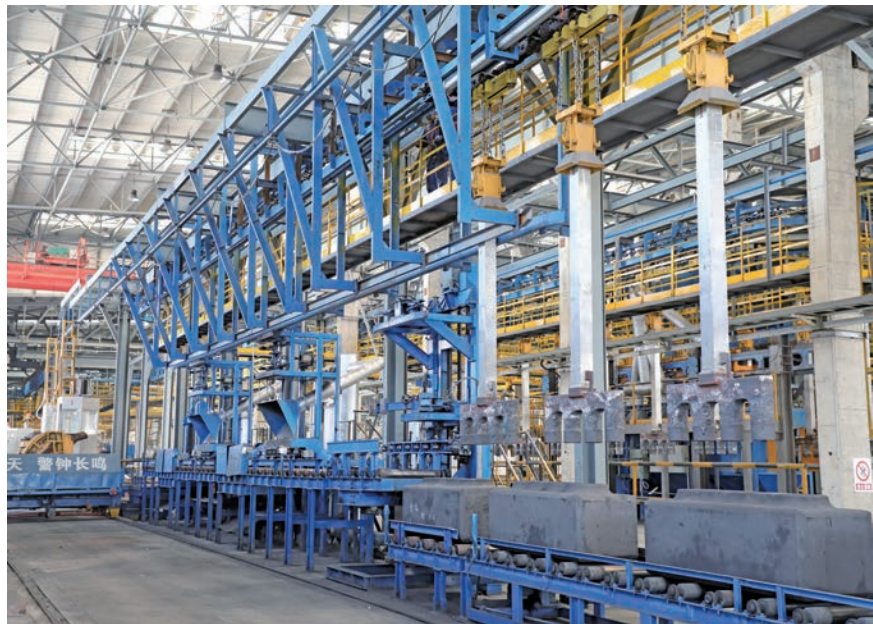
云南神火采用先进的宽推杆积放式悬挂输送系统
